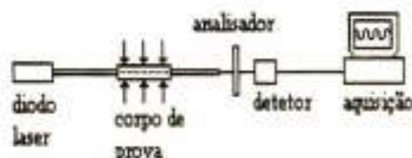
Fig. 2 - Esquema de montagem do ensaio experimental.
