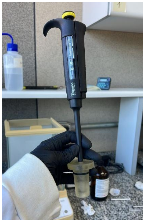
Figura 7: Sistema adaptado para uma pipeta volumétrica no sistema de gotas
